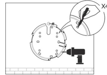
1 이더넷 케이블이 벽을 통과하면 마운팅 브라켓을 케이블 아래로 위치시킵니다. 4개의 스크류 구멍을 표시하고 표시된 위치에 직경 6 mm (15/64 인치)의 구멍 4개를 드릴로 뚫습니다.
