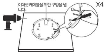
2 천장 타일 중앙에 마운팅 브라켓을 놓습니다. 네 개의 스크류 구멍과 이더넷 케이블 구멍의 위치를 표시합니다. 표시한 위치에 스크류를 넣을 직경 4 mm (5/32 인치)의 구멍 4개와 이더넷 케이블을 넣을 직경 25 mm (63/64 인치) 구멍 1개를 드릴로 뚫습니다.
